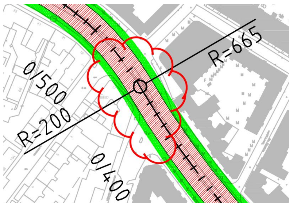
Figur 22 Tunnelprofil og arbejdsareal (grøn skravering er nødvendigt arbejdsareal)
