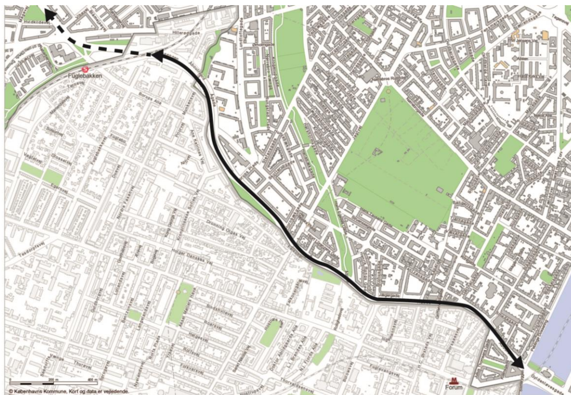
Figur 1. linjeføring af tunnel med indikation af alternativ slutning ved S-banen.
